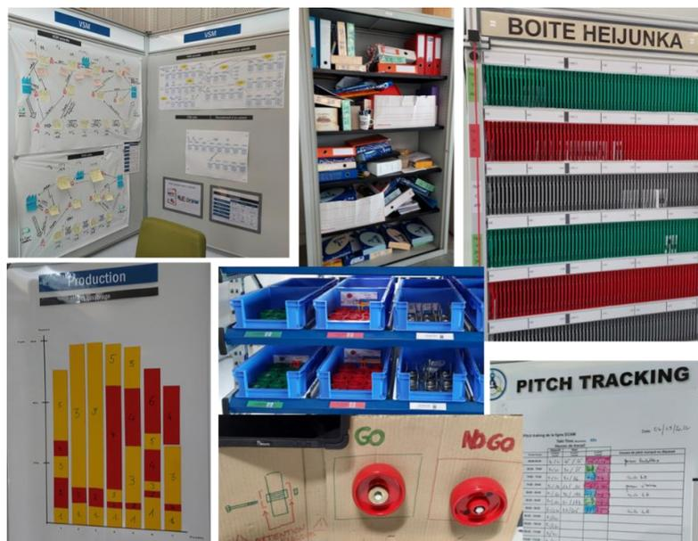
Dans le laboratoire de production, je vois une cellule en U équipée avec une boîte de lissage (*heijunka box*), des kanbans, un petit train, des fiches standards, des stocks pied de ligne, un tableau de production, et ainsi de suite.
